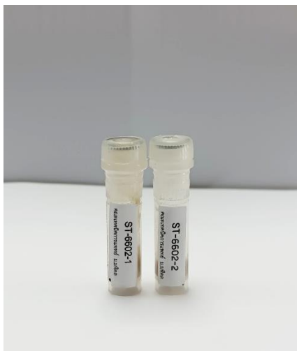
ตัวอย่างทดสอบปริมาณ 0.5 ml บรรจุในหลอดพลาสติกฝาเกลียวปิดทับด้วยพาราฟิล์ม
